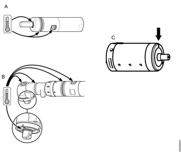
Las temperaturas más altas se producen cuando el motor funciona a máxima presión sin carga. Al aumentar el par, el motor de aire reduce la velocidad de rotación y la temperatura.
