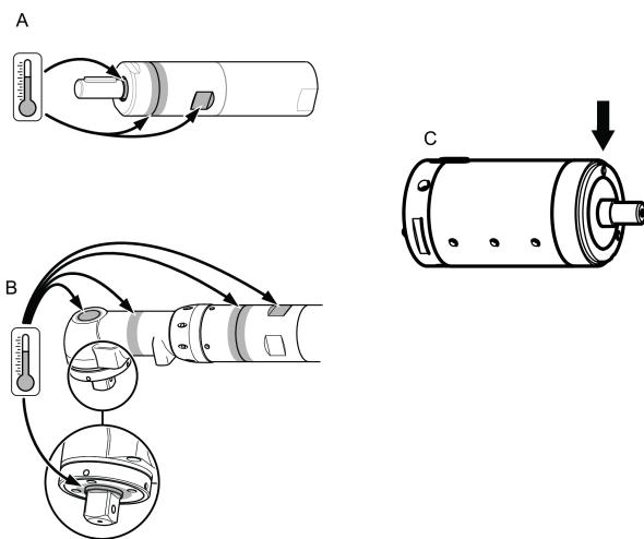
Motor yüksüz tam basınç altında çalışırken en yüksek sıcaklıklar meydana gelir. Artan tork ile birlikte, hava motoru dönüş hızını ve sıcaklığını azaltır.
