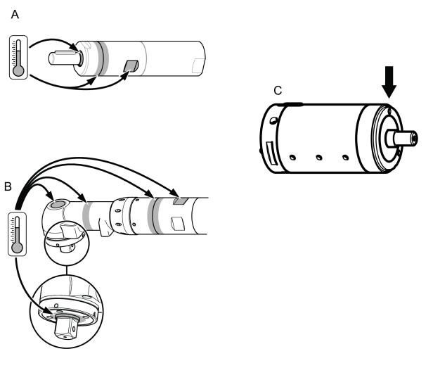
马达在全压空载运行时，温度将达到最高。随着扭矩的增大，气动马达的旋转速度和温度将会降低。
