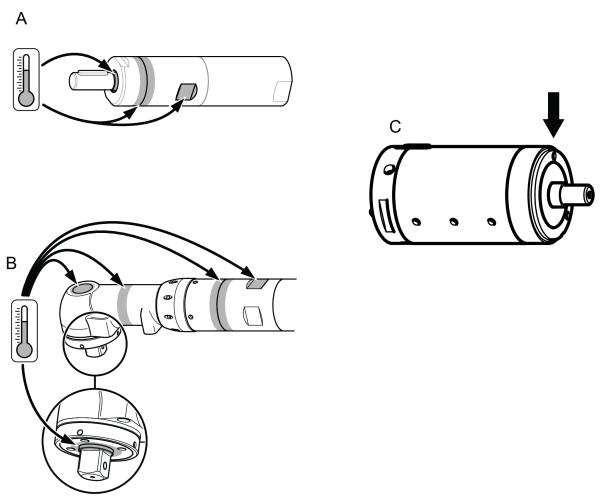
Най-високите температури се появяват, когато двигателят работи на пълни обороти без натоварване. С увеличаване на въртящия се момент пневматичният двигател намалява скоростта на въртене и температурата.
