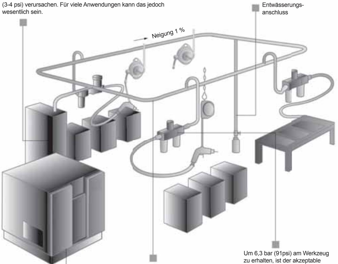
Ein normaler Kompressor kann bis zu 7,5 bar (109 psi) für den Luftleitungsdruck liefern, abhängig von den Start- und Stoppeinstellungen.
