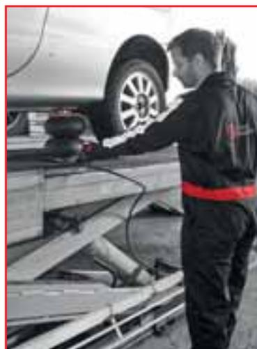
Ballon-Heber können auf Hebebühnen verwendet werden. Ideal für Reifenwechsel und Lackierereien
